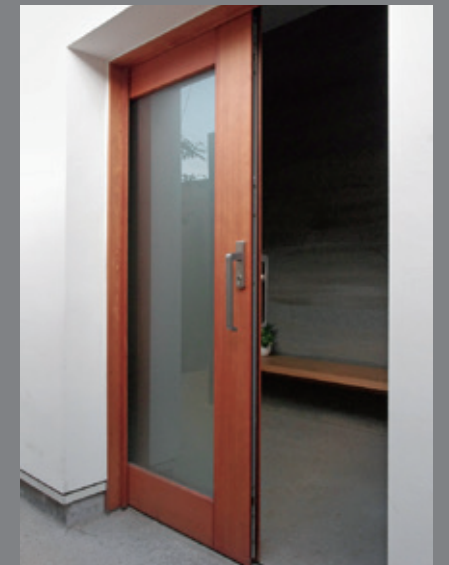
8. 框型 1本引・ガラスなし(扉内動) 樹種：米松ピーラー サイズ：FW2577×FH1939 塗装：Livos カルデットシリーズ/チーク
