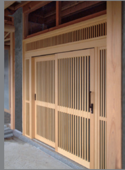
2. T型 欄間+両袖FIX付き 引き違い 樹種：米ヒバ サイズ：FW2600×FH2350 塗装：Livos カルデットシリーズ/クリアー
